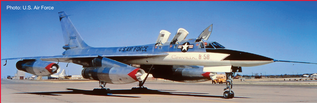
559850 U.S. Air Force Convair XB-58 Hustler – 55-0660 mit abnehmbarem Fahwerk / with removable landing gear.
